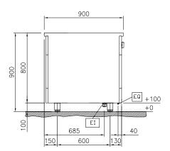
Electrical inlet (power) EQ Equipotential screw
